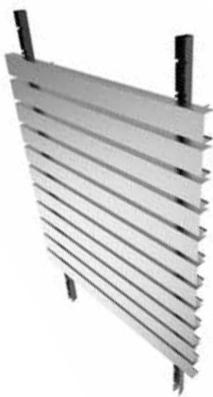
Serie U81 F con lamelle in alluminio profilato sezione alta 39 mm e base 81 mm, posizionata con sistema di supporto profili ad U da 37 x 37 mm, in acciaio zincato o alluminio, per il montaggio di lamelle separate. Molto decorativo, facilmente rimovibile e con accesso posteriore permanente alla eventuale registrazione degli impianti. Disponibile nella gamma di Colori RAL. È particolarmente adatto per rivestimenti e controsoffitti.
